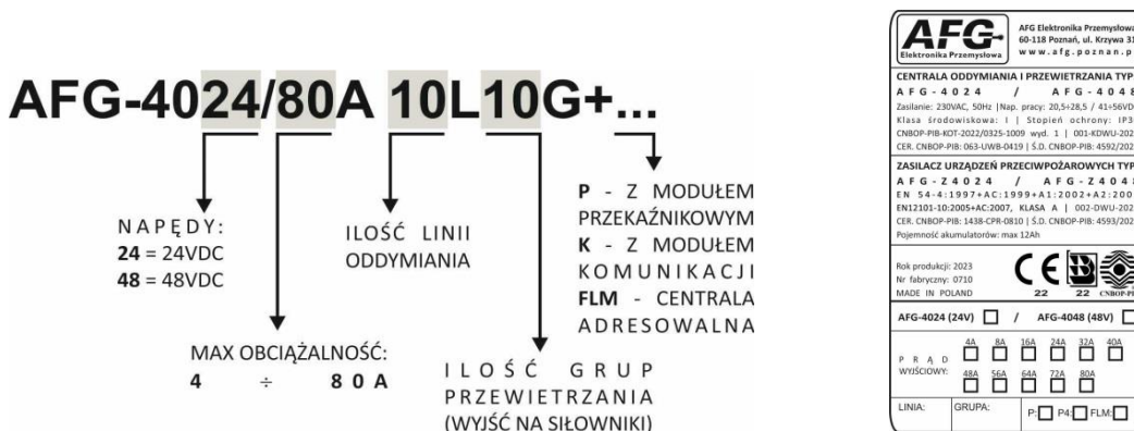
Rysunek 2. Oznaczenie typu, tabliczka znamionowa dla AFG-4024/4048
